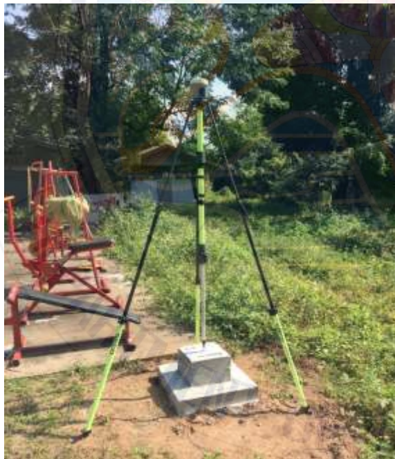
รูปที่ 3-6 การรังวัดหาค่าพิกัดด้วยเครื่องรับสัญญาณดาวเทียม GNSS (Static)
