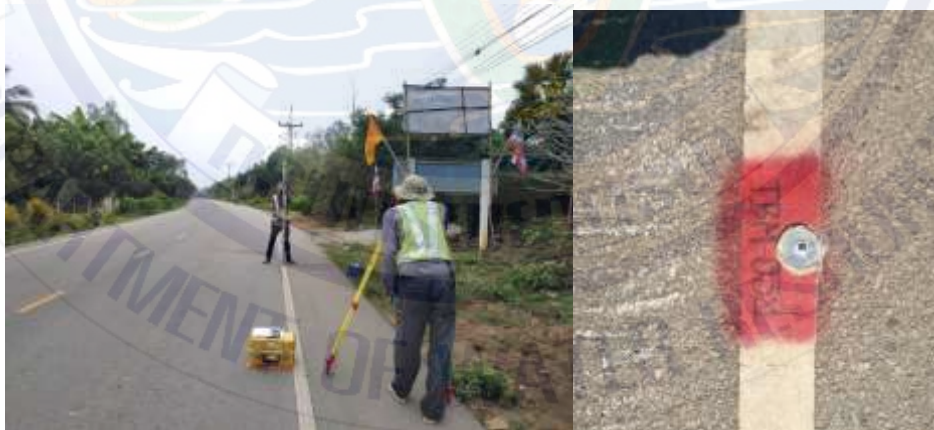
รูปที่ 3-12 หมุดชั่วคราว (TBM) ตลอดสายการระดับโครงการ
