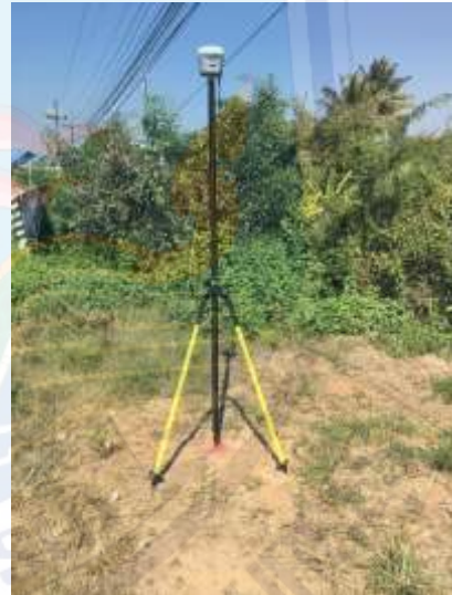
รูปที่ 3-9 การรังวัดหาค่าพิกัดด้วยเครื่องรับสัญญาณดาวเทียม GNSS (RTK)
